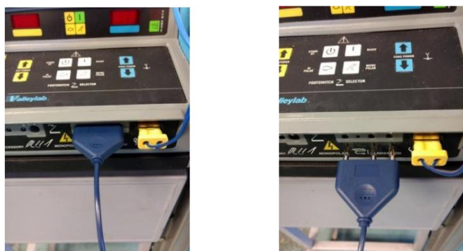
Figura 4.7: Conexão do cabo eletrocirúrgico do interruptor manual monopolar
