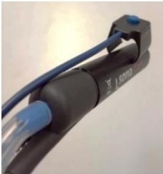
Figura 4.4: Conexão da caixa do interruptor manual monopolar
