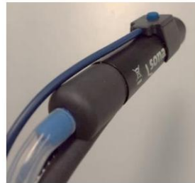
Figura 4.3: Conexão do cabo da peça de mão do comutador monopolar
