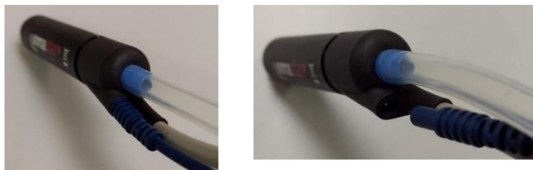
Figura 4.5: Conexão do cabo da peça de mão do comutador monopolar
