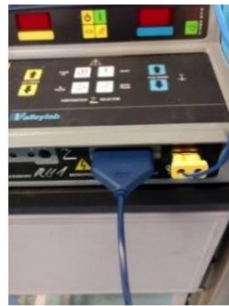
Figura 4.5: Conexão do cabo eletrocirúrgico do interruptor manual monopolar
