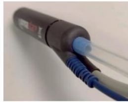
Figura 4.3: Conexão do cabo da peça de mão do comutador monopolar
