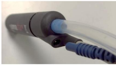
Figura 4.3: Conexão do cabo da peça de mão do comutador monopolar
