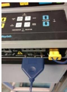
Figura 4.5: Conexão do cabo eletrocirúrgico do interruptor manual monopolar
