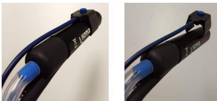
Figura 4.6: Conexão da caixa do interruptor manual monopolar
