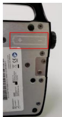
Figura 10-5: Polaridade da bateria
